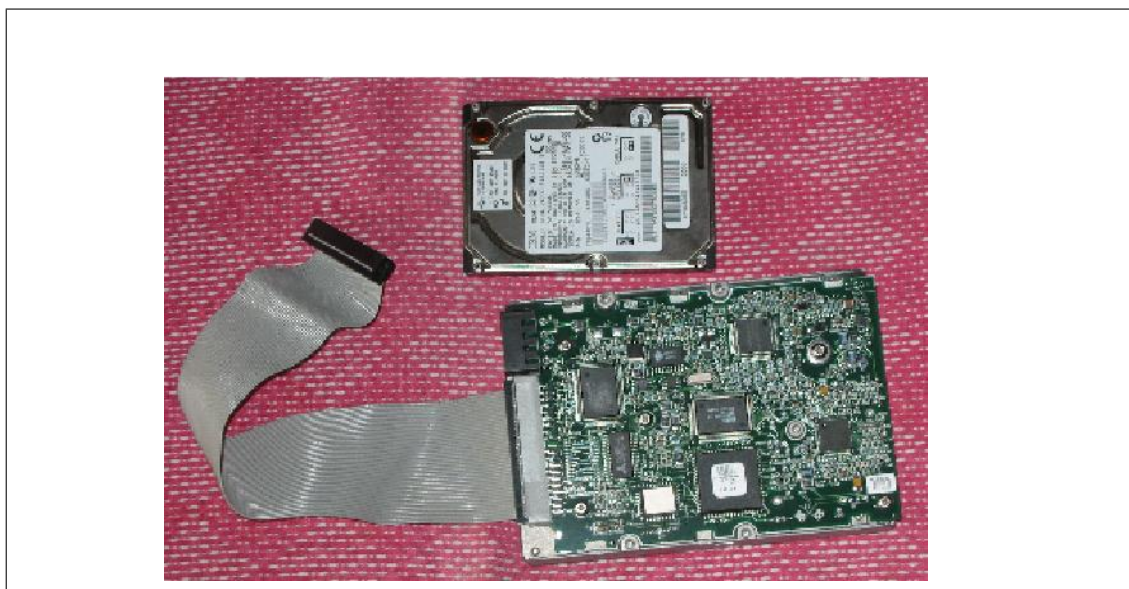
Risa/Asir ドリル ギャラリー : ハードディスク (Harddisks). 大きい方はデスクトップコンピュータ用, 小さい方はラップトップコンピュータ用. テキストファイルはハードディスクに文字コードを用いて格納されている.
